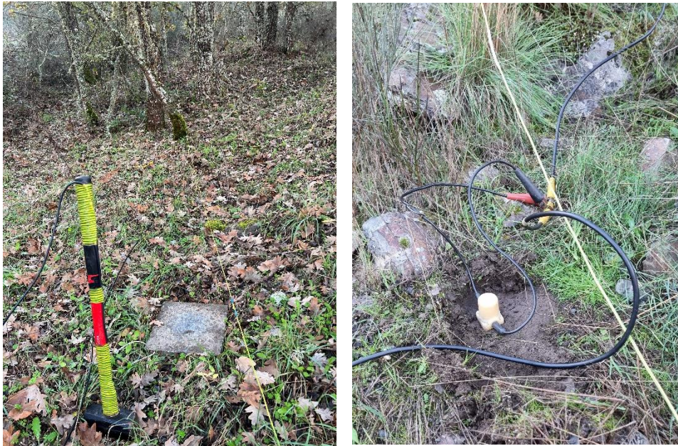
Figura 4. Fuente de energía (izda) y geófono de 14 Hz (dcha)
