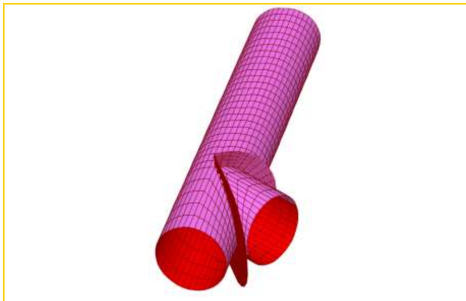
Imagen 24. Tubería forzada. Bifurcación 2. Modelo de cálculo
