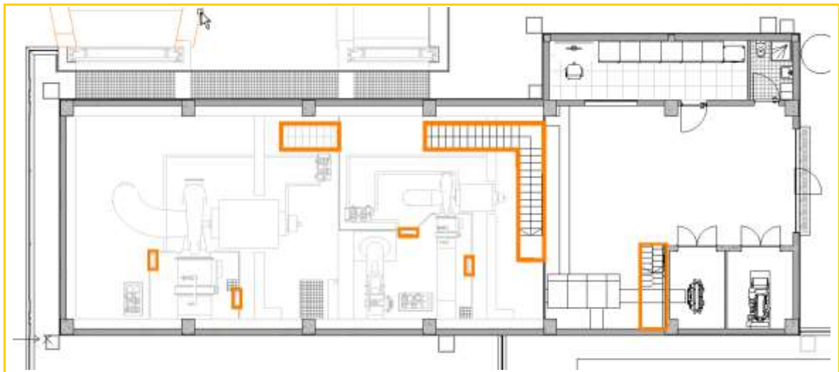
Imagen 14. Escaleras de conexión entre niveles.
