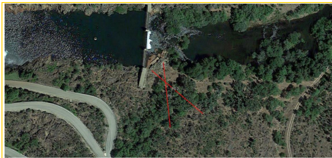
Imagen 53. Localización de los perfiles de tomografía sísmica para el estudio del emplazamiento de la Casa de Máquinas y la Subestación eléctrica.
